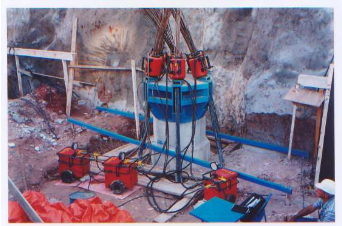
Figura 16 – Montagem com 6 tirantes (12Ø12,5mm) inclinados para 1.000 tf
