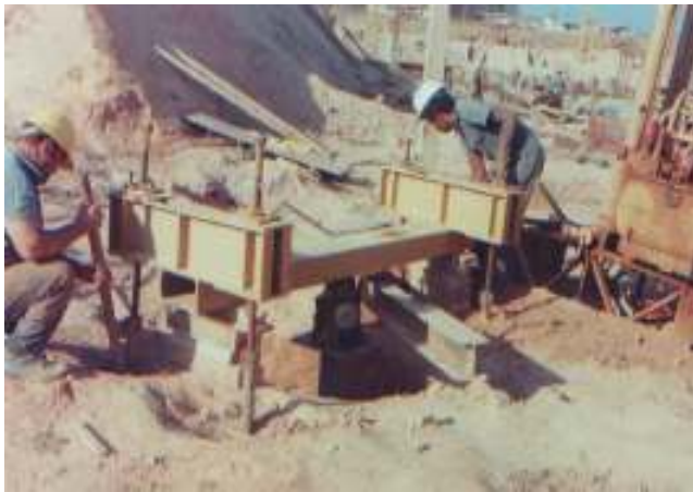
Figura 3 – Prova de carga em placa
