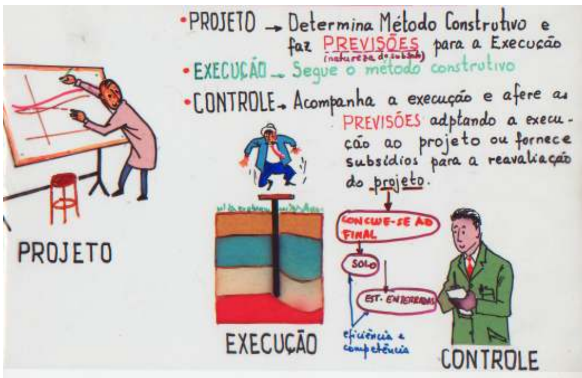
Figura 2 – Tripé da boa fundação
